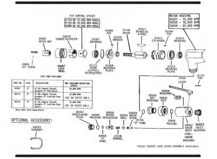
TOOL RPM RATING MUST NEVER EXCEED ABRASIVE/ACCESSORY RPM RATING, REGARDLESS OF THE TOOL'S CAPACITY.
